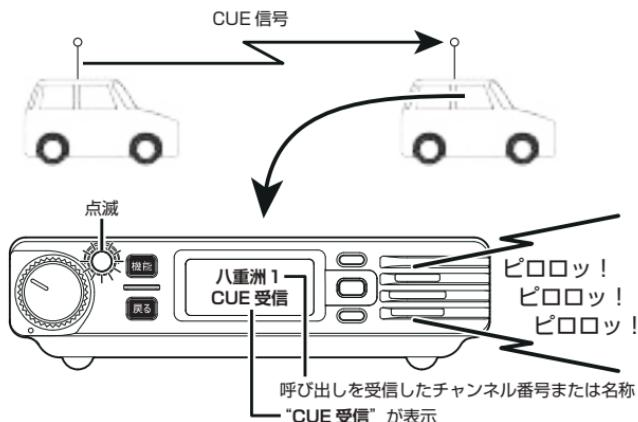
CUE を受信した後にマイクロфонの PTT スイッチを押すと、CUE (キュー) を送信した相手のチャンネルで送信します。
