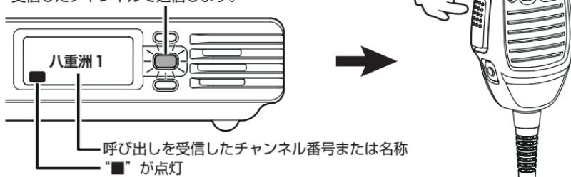
[P1] キーの点滅が点灯に変わると再びマルチチャンネル待ち受け動作を開始します。
